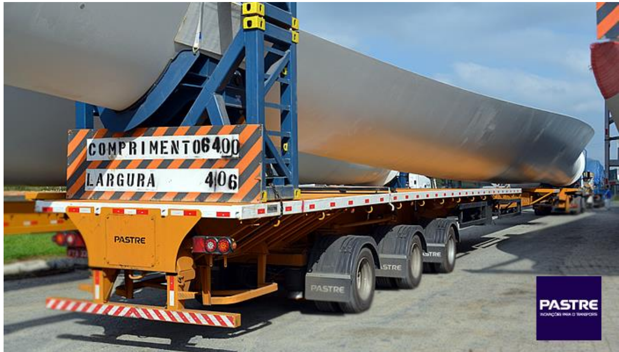
Figura 9. Exemplos de comprimento e largura do semirreboque de transporte de pá. Fonte: http://www.pastre.com.br/pastrinho/2014/05/semirreboques-pastre-transportam-pas-eolicas-de-60-metros/
